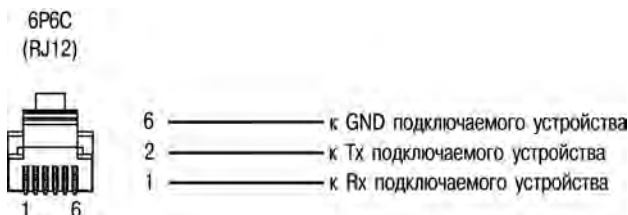
Рисунок В.3 – Схема кабеля для подключения ПЛК63 к порту RS-232
